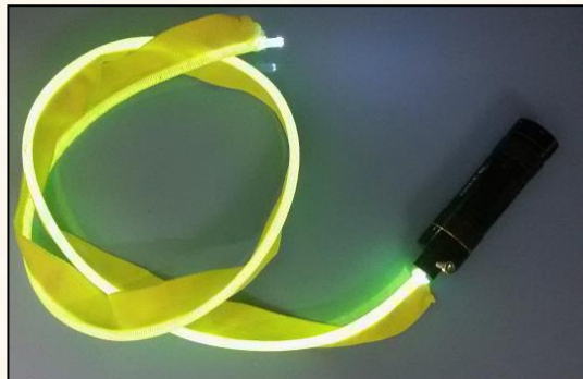
Przykład światłowodów typu SEPOF (producent: SCILIF, Czechy)
